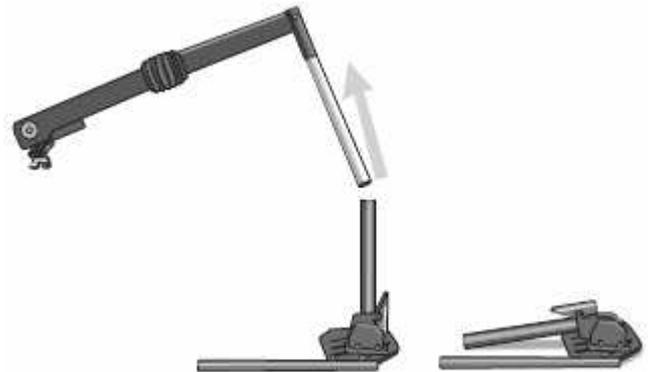
Lorsque la grue est inutilisée, il est facile d'enlever le mat (11 kg) de la hampe de fixation. Cette dernière peut ensuite se rabaisser sur le plancher du véhicule.
